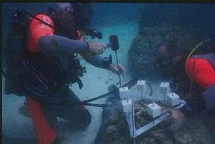
**TECHNIQUE BIS.** Manipulation dite de bioérosion consistant à mesurer dans le temps l'érosion du squelette corallien due à des microorganismes.
