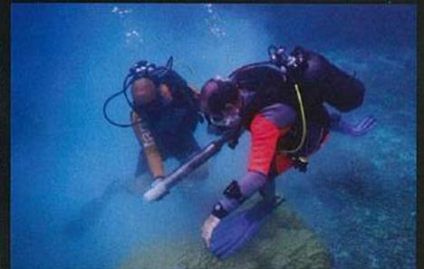
**TECHNIQUE.** Forage en vue de l'obtention d'une carotte dans un corail massif (*Porites*). Le « trou » laissé sera ensuite rebouché.
